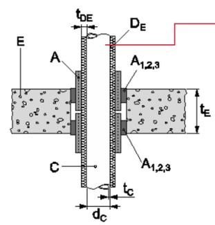
RAME c/ isolamento a base di gomma da 10 a 35 mm max (+ 42 mm)
