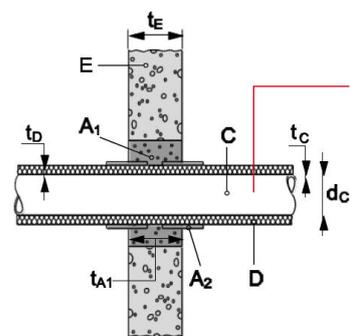
RAME c/ isolamento a base di gomma da 10 a 35 mm
