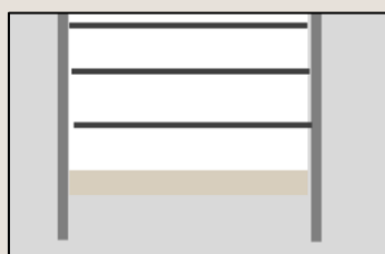
Fissaggio dei puntoni in CLS per il sostegno dello scavo
