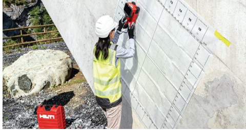
а) Сканування на наявність ферумовмісних об'єктів
