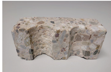
б) Відмінність між шорстким і гладким буровим отвором у бетоні
