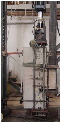
а) Типовий зразок та установка для випробувань, використані для побудови моделі зсувного тертя (розміри наведено в метрах)
