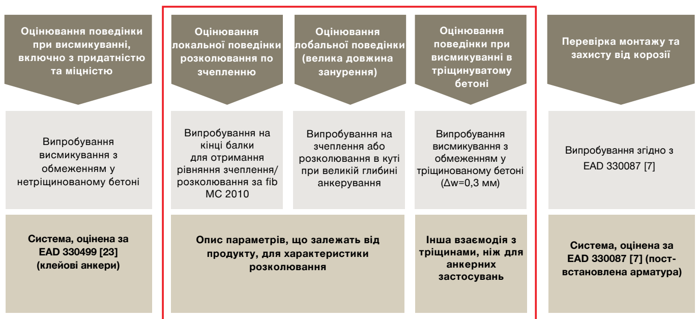
Рис. 3.7 — Оцінка пост-встановленої арматури згідно з EAD 332402 [10]
