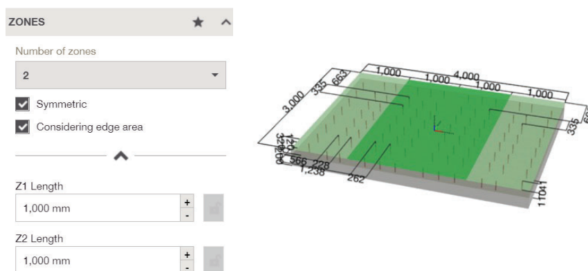
Рис. 8.12 — Поділ плити нарощування на зони для розрахунку
