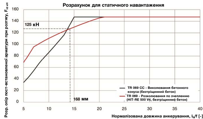
Рис. 6.20 — Графічне відображення необхідної довжини анкерування для випадку статичного навантаження
