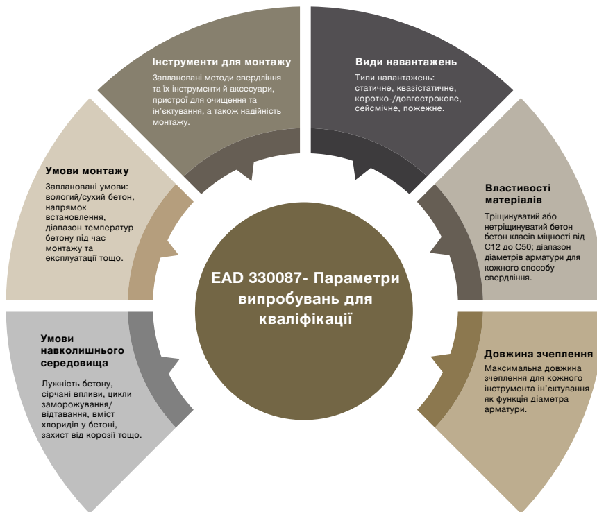
Рис. 3.6 – EAD 330087: параметри випробувань для кваліфікації [7]
