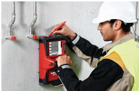
c) Сканування на наявність ферумовмісних і неферумовмісних об'єктів
