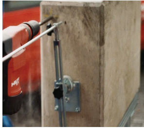
Рис. 9.7 — Приклад напрямного пристрою для свердління
