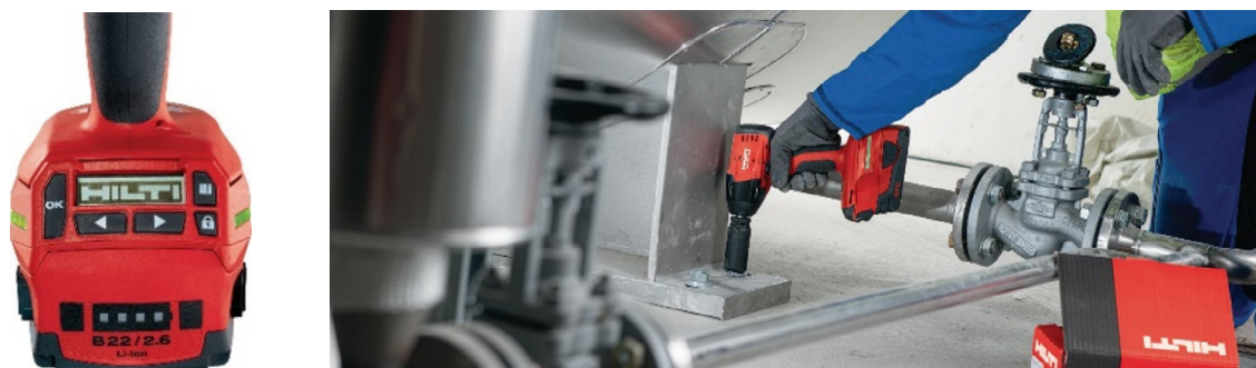
Рис. 8.10. Система модуля з регульованим крутним моментом (АТ) для ударного гайковерта Hilti
