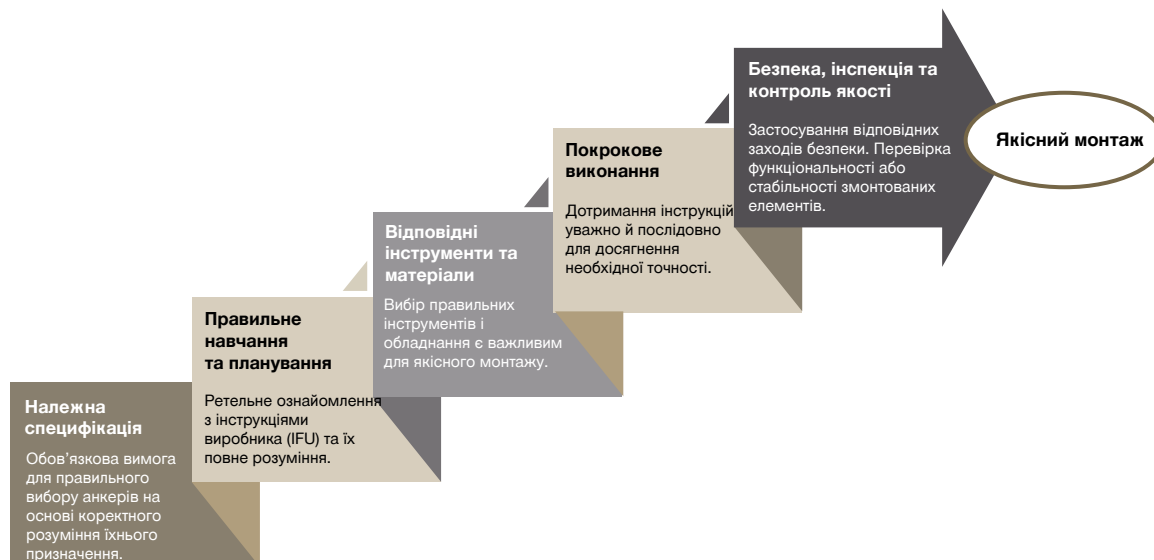
Рис. 8.1: Основні етапи, яких слід дотримуватись для правильного монтажу
