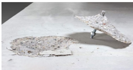
Мал. 3.16: Руйнування бетонного конуса при навантаженні на розтяг.
