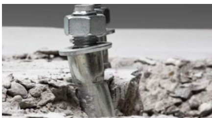
Рис. 3.22 — Руйнування бетону шляхом виколювання при навантаженні на зсув
