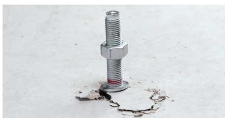
Рис. 3.17 — Руйнування шляхом висмикування при навантаженні на розтяг
