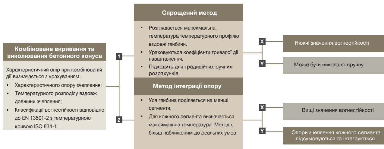
Рис. 6.42 — Основні характеристики методів розрахунку для комбінованого виривання та виколювання бетонного конуса згідно з EOTA TR 082 [46]
