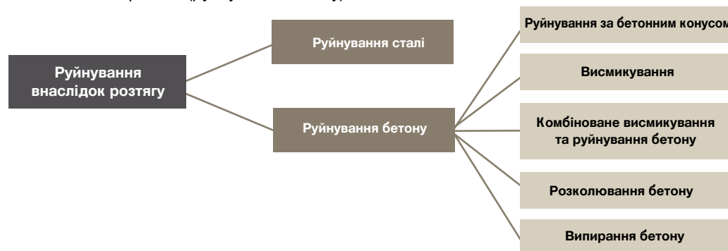
Рис. 3.13 — Різновиди руйнування при навантаженні на розтяг
