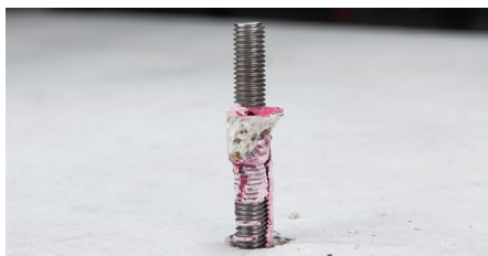
Рис. 3.18 — Комбіноване руйнування: висмикування та виколювання бетону при навантаженні на розтяг
