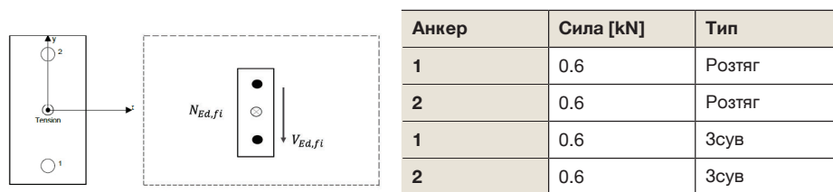
Рис. 6.49 — Аналіз сил в анкерному з'єднанні
