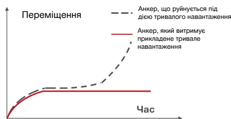
Рис. 3.29 — Вплив тривалого розтягувального навантаження на поведінку за переміщенням
