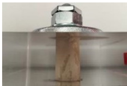
б) Набір для заповнення Hilti під час монтажу
