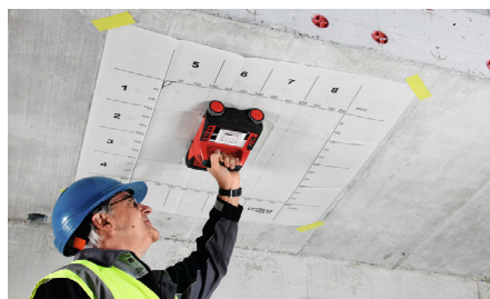
с) Сканування феромагнітних і немагнітних об'єктів
