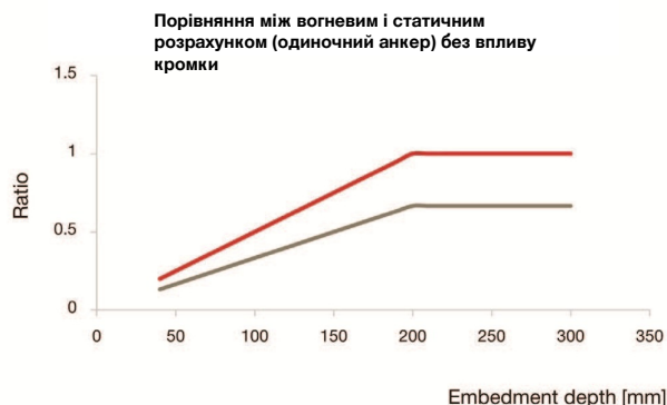
Рис. 6.41 — Коефіцієнт зниження для опору виколуванню бетонного конуса
