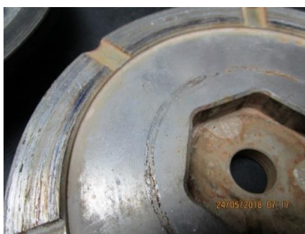
Figura 3: Flangia con diametro esterno consumato
