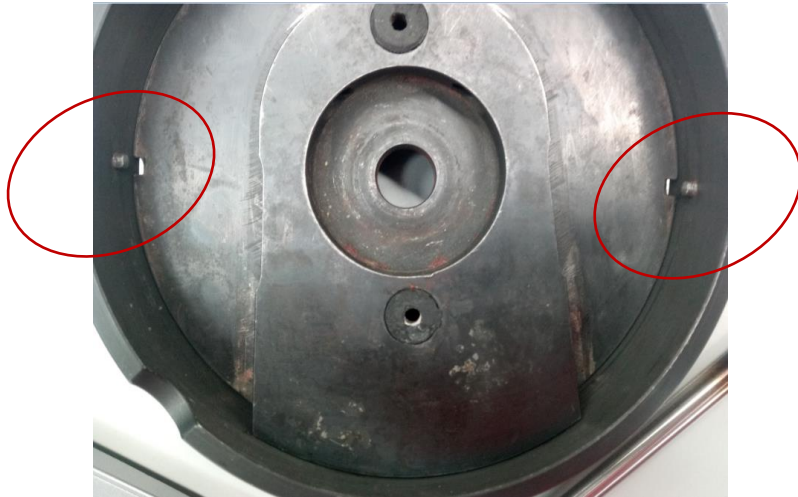
Figura 5: Gli spinotti garantiscono il movimento lineare degli anelli e tengono gli anelli in posizione durante l'operazione. Se uno o entrambi gli spinotti sono danneggiati, il funzionamento non è più garantito.
