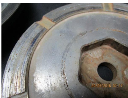
Figura 3: Flangia con diametro esterno consumato
