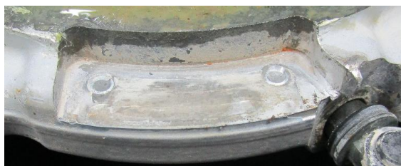
Figura 6: Blocco di sicurezza mancante.
