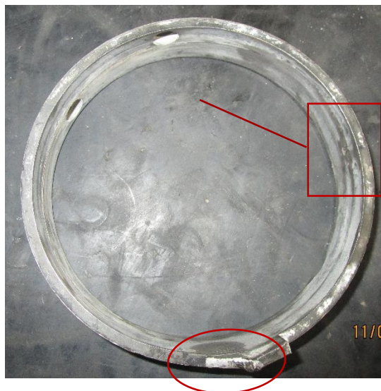
Figura 7: Anelli danneggiati con blocco di sicurezza rotto e spinotti mancanti.
