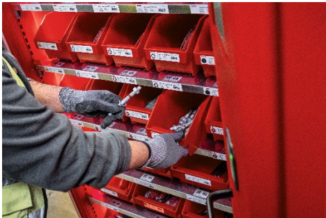
Bild 3: Entnahmen aus dem Connected Locker sind rückverfolgbar und Projekten zugebucht.
